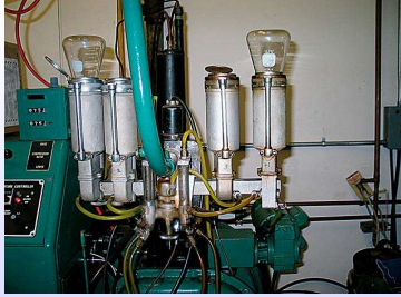
Emme manifoldu ortada, kalibrasyon yakıt kapları solda, test yakıt kapları sağda
